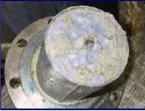
RCP anotlarının erimesi
